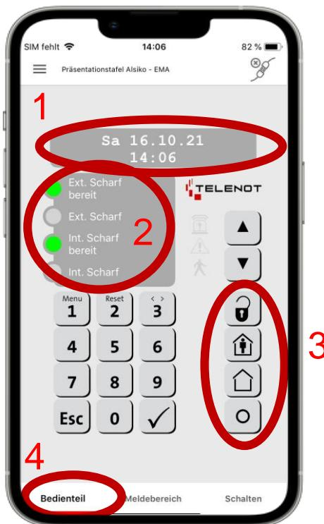
Das APP-Bedienteil (4) hat die selben Funktionen wie die Bedienteile in Ihrem Objekt. Die einzigen Unterschiede findet man bei der LED - Anzeige (2) und der freigegebenen Tasten (3).
